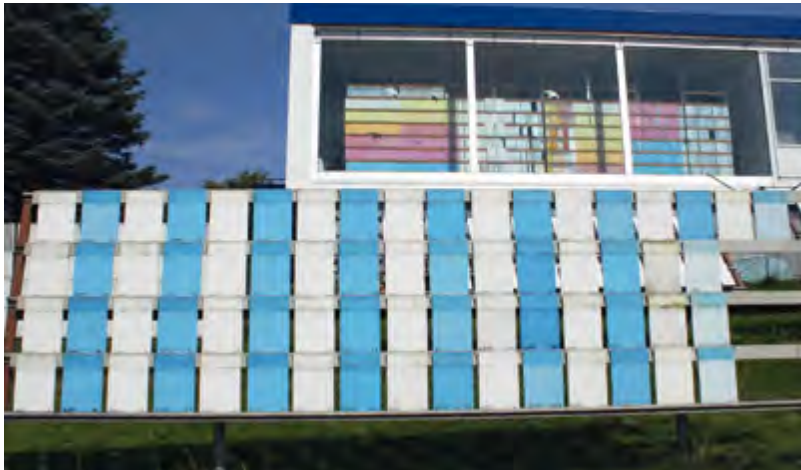
Abb. 2: KRONOS Teststation® Engstenberg, Fassadenfarbe PVK 47%, Polymerdispersionen mit jeweils zwei Titandioxidpigmenten
