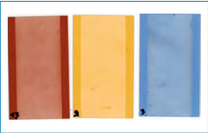
Abb. 7: Farbtonerhöhung eingefärbter Kunststoffe nach WOM-Bewitterung
